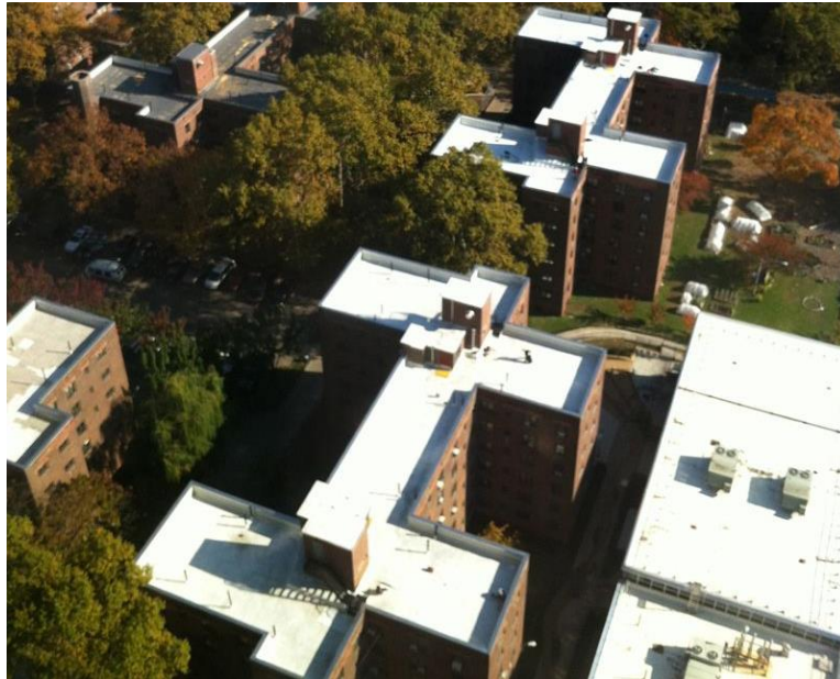
The White Roof Project : prise de vue aérienne des toits repeints en blancs à Brooklyn
